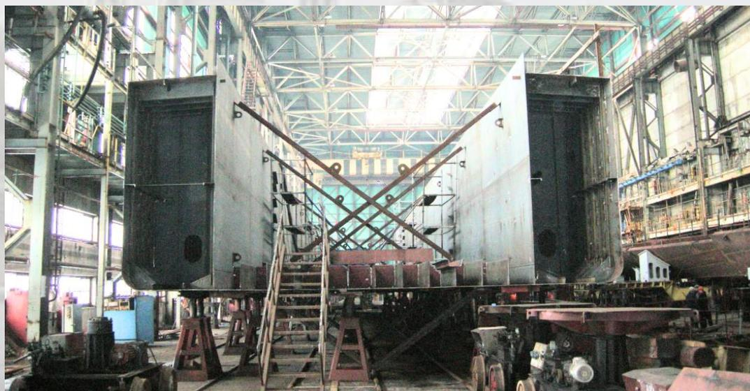
Сборка блоков и секций весом более 20 т. производится в стапельно-монтажном цехе (закрытом эллинге).
