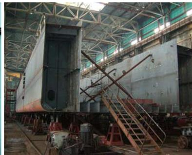
**Сборка (формирование из блоков и секций) корпуса производится как в стапельно-монтажном цехе (закрытом эллинге), так и на открытом стапеле.**
